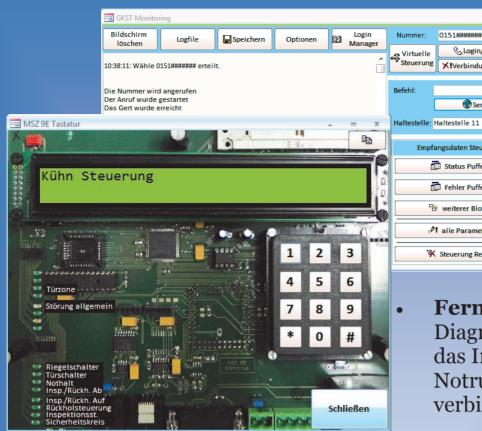
Ferndiagnose. Unsere Diagnose-Software kann sich über das Internet (mit entsprechendem Notrufgerät) mit der Steuerung verbinden.
